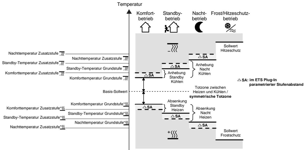
In der Betriebsart "Heizen und Kühlen" können 6 Temperatur-Sollwerte, falls in der ETS freigegeben, verändert werden. In Abhängigkeit der in der ETS parametrieren Temperatur-Absenkung, -Anhebung oder Totzone leiten sich alle Temperatur-Sollwerte aus der Basis-Solltemperatur ab.
