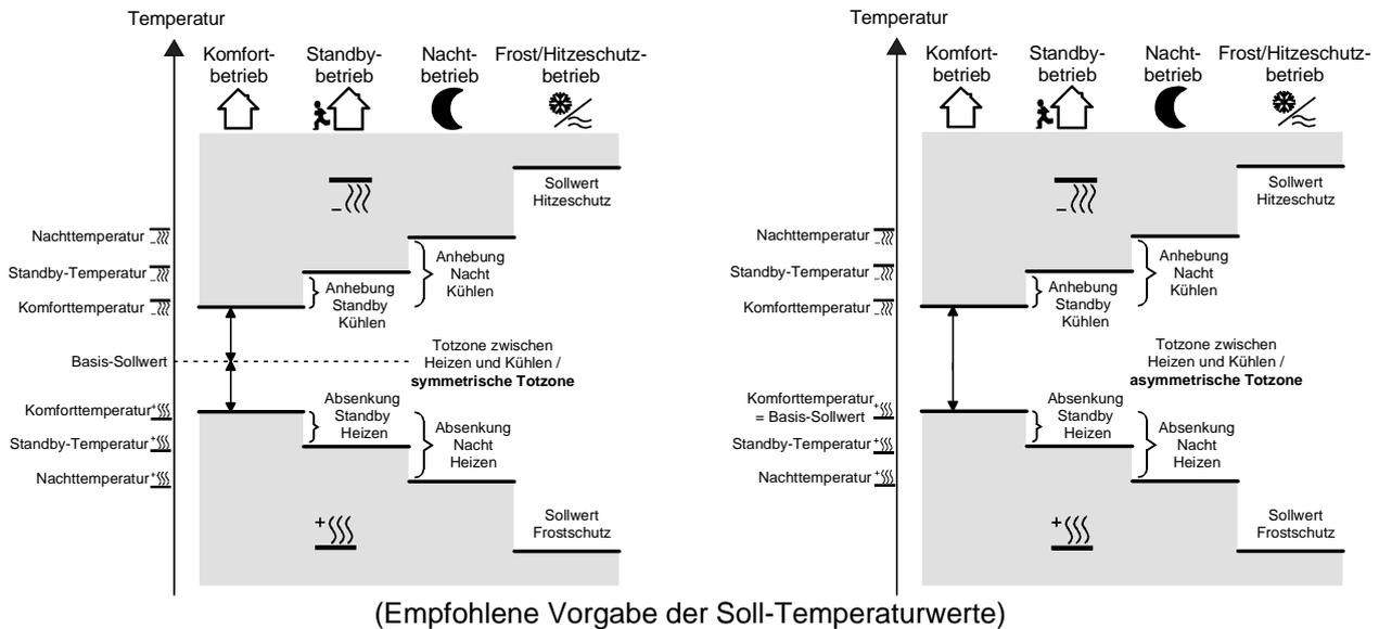
In dieser Betriebsart existieren die Solltemperaturen für Komfort-, Standby- und Nachtbetrieb beider Betriebsarten sowie die Totzone. Zusätzlich können die Frostschutz- und die Hitzeschutztemperaturen vorgegeben werden. Dabei gilt:
