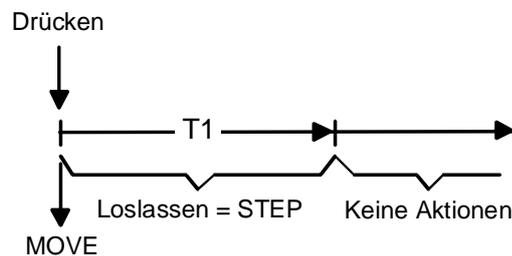
Mit dem Drücken der Taste wird ein Move gesendet und die Zeit T1 ("Lamellenverstellzeit") gestartet. Wenn dann innerhalb von T1 wieder losgelassen wird, sendet der Binäreingang ein Step-Telegramm aus. Diese Funktion wird zur Lamellenverstellung benutzt. T1 sollte der Zeit einer 180° Lamellendrehung entsprechen.
