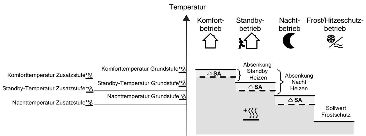
$$T_{\text{Komfort-Soll Zusatzstufe Heizen}} \leq T_{\text{Komfort-Soll Grundstufe Heizen}} / T_{\text{Standby-Soll Zusatzstufe Heizen}} \leq T_{\text{Standby-Soll Grundstufe Heizen}}$$
