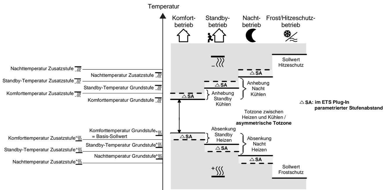
$$T_{\text{Komfort-Soll Zusatzstufe Heizen}} \leq T_{\text{Komfort-Soll Grundstufe Heizen}} \leq T_{\text{Komfort-Soll Grundstufe Kühlen}} \leq T_{\text{Komfort-Soll Zusatzstufe Kühlen}}$$
