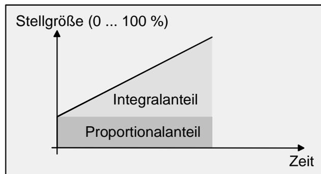
Eine Zusatzheiz- oder Zusatzkühlstufe als PI-Regelung funktioniert genau wie die PI-Regelung der Grundstufe mit dem Unterschied, dass sich der Sollwert unter Berücksichtigung des parametrisierten Stufenabstands verschiebt.
