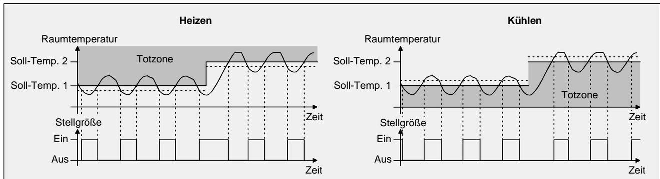
Eine Zusatzheiz- oder Zusatzkühlstufe als 2-Punkt-Regelung funktioniert genau wie die 2-Punkt-Regelung der Grundstufe mit dem Unterschied, dass sich der Sollwert und die Hysterese werte unter Berücksichtigung des parametrisierten Stufenabstands verschieben.
