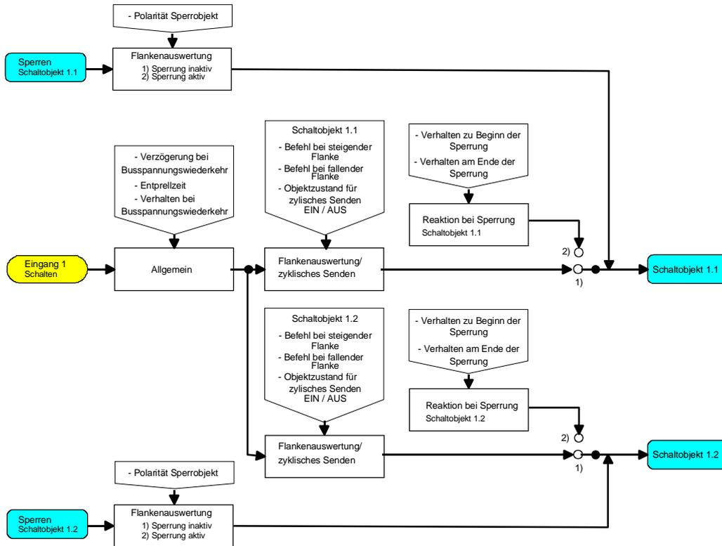
Funktionsschaltbild (für Binäreingang / z. B. Eingang 1 Funktion "Schalten")
