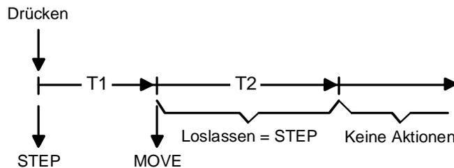
Mit dem Drücken der Taste wird ein Step gesendet und die Zeit T1 ("Zeit zwischen Kurz- und Langzeitbetrieb") gestartet. Wenn innerhalb von T1 wieder losgelassen wird, wird kein weiteres Telegramm gesendet. Dieser Step dient zum Stoppen einer laufenden Dauerfahrt.
