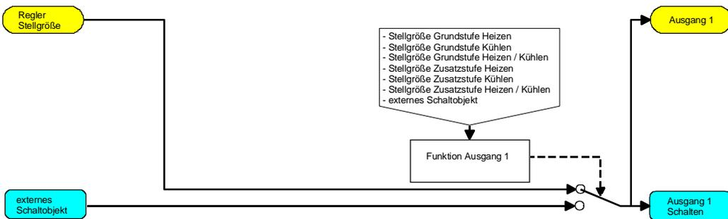
Funktionsschaltbild (für Schaltausgänge / z. B. Ausgang 1)
