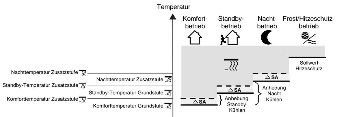
$$T_{\text{Komfort-Soll Grundstufe Kühlen}} \leq T_{\text{Komfort-Soll Zusatzstufe Kühlen}} \quad / \quad T_{\text{Standby-Soll Grundstufe Kühlen}} \leq T_{\text{Standby-Soll Zusatzstufe Kühlen}}$$
