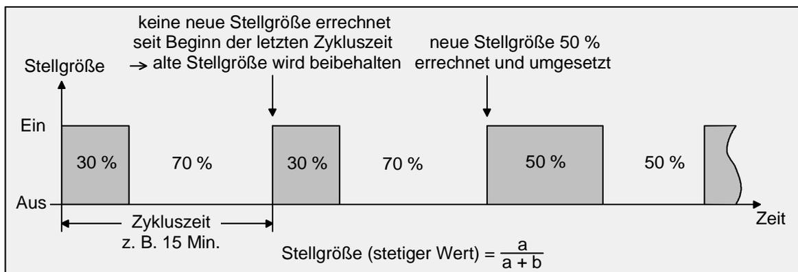
Bei einer Stellgröße von 0 % (dauernd ausgeschaltet) oder 100 % (dauernd eingeschaltet) wird nach Ablauf einer Zykluszeit stets ein Stellgrößentelegramm entsprechend des Stellgrößenswertes ("0" oder "1") ausgegeben. Auch das 'Clipping' (vgl. "stetige PI-Regelung") ist bei dieser Regelungsart aktiv.
